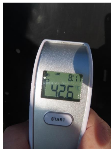
Obrázok č. 2: Teploty namerané 2. marca 2021 na povrchu nádoby a vo vnútri nádoby. Nádoba bola umiestnená na slnku pri vonkajšej teplote +10 °C.
